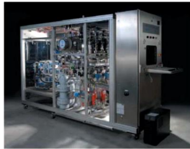
a) unité composée de plusieurs microréacteurs en verre permettant une production annuelle jusqu'à 40 tonnes (Corning - Zeton).
