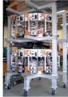
b) unité constituée de 22 microréacteurs CYTOS® ayant une capacité maximale de production de 20 tonnes/an.
