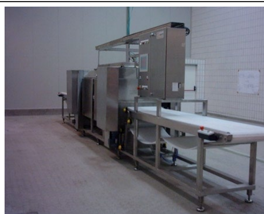
Figure IV.15: Micro-ondes continu de 915 MHz pour tempérer de -20 à -4/-2 °C des quantités de 1,25 à 1,5 t/h)
