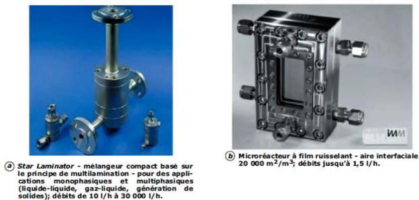
Figure II.13 : Deux exemples de micromélangeurs pour applications gaz-liquide
