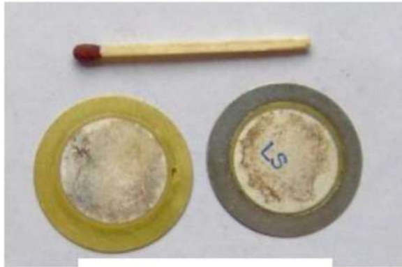
Éléments piézoélectriques de montre
