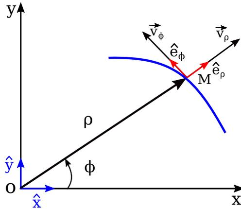
FIGURE 2.8 – Vitesse radiale et vitesse tangentielle
