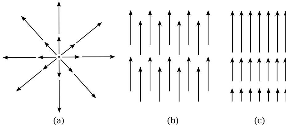
FIGURE 1.15 – Sens géométrique de la divergence
