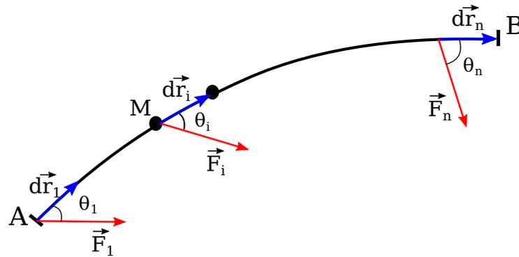
FIGURE 4.2 – Circulation d’une force sur un trajet et travail total
