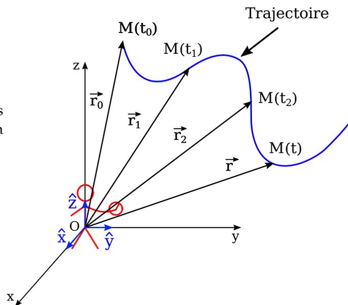
FIGURE 2.2 – Trajectoire et vecteurs positions d'un mobile
