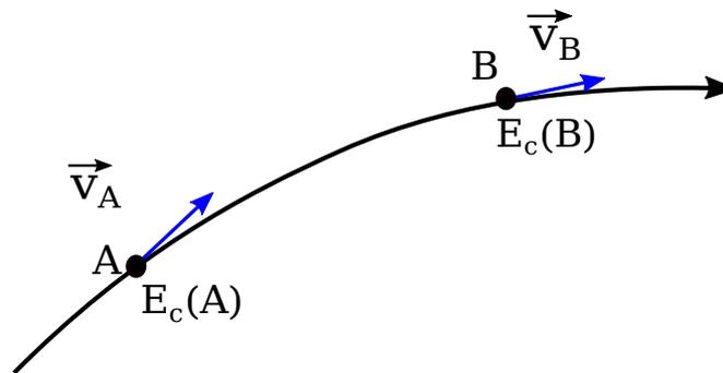
FIGURE 4.5 – Variation de l'énergie cinétique et travail des forces extérieures
