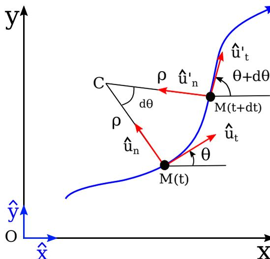
FIGURE 2.10 – Centre et rayon e courbure de la tajoctoire en un point M
