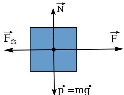
FIGURE 3.3 – Forces de frottement statique
