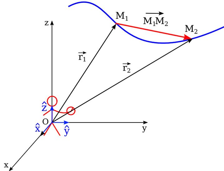
FIGURE 2.4 – Vecteurs déplacement d'un mobile
