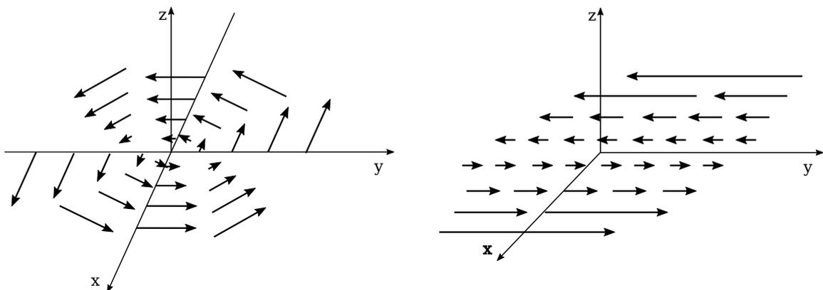
FIGURE 1.16 – Sens géométrique du rotationnel
