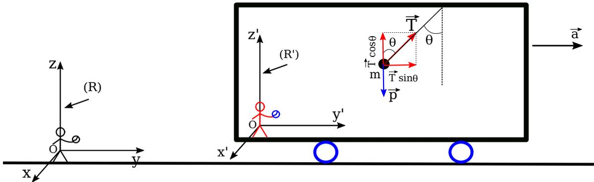
FIGURE 3.5 – Forces d'inertie
