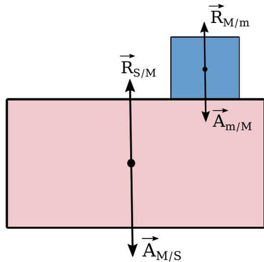
FIGURE 3.1 – Forces d'action et de réaction
