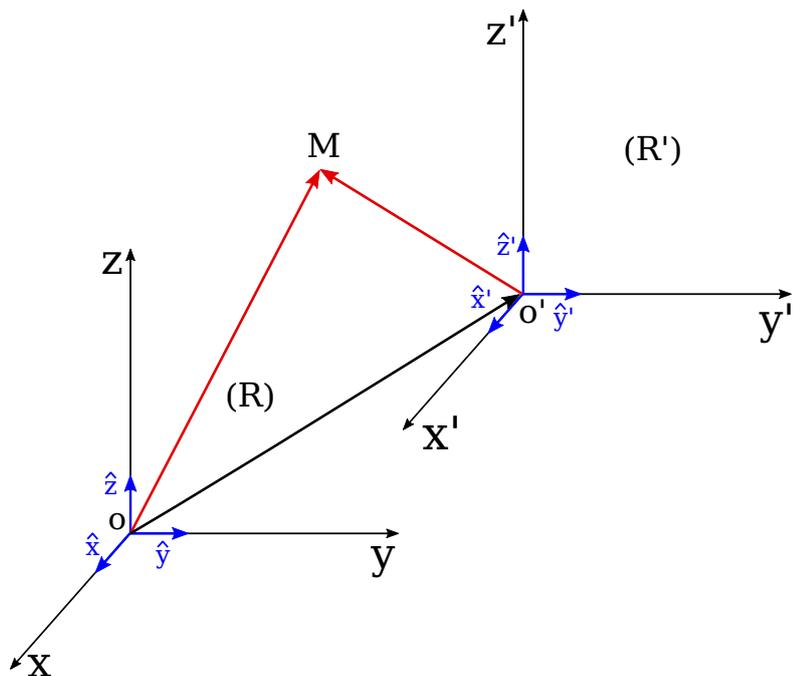
FIGURE 2.12 – Mouvement d'un point M dans deux référentiels R et R'.
