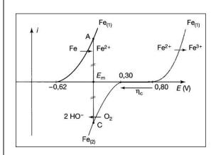
➤ La réaction globale se produit avec une vitesse v caractérisée par l'intensité i. On peut montrer (cette étude sort du cadre du programme) que l'intensité varie exponentiellement avec le potentiel E : i □ Ae. BE., A et B étant des constantes, dépendant du couple électrochimique étudié et de la température.
