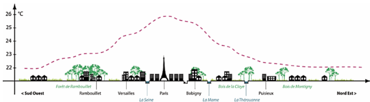
Figure 15 : Coupe schématique de visualisation des températures en 2008 pour une nuit de canicule (type été 2003) © Groupe DESCARTES - Consultation internationale de recherche et de développement sur le grand pari de l'agglomération parisienne, 02/2009
