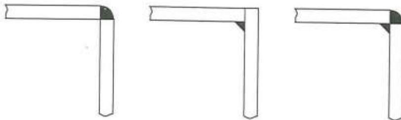
**Fig.3.7** Soudure d'angle
