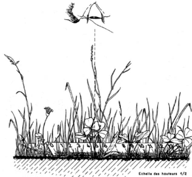
Fig.10 - Le double-mètre, en place dans la végétation et le mode de visée (extrait de Daget & Poissonet, 1971)
