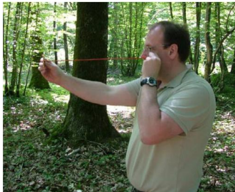
Fig.14 -Méthode d'utilisation de la chaîne relascopique (©Lemaire J.)
