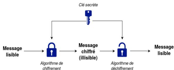
Figure 2.1: Shéma de cryptographie symétrique
