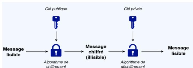
Figure 2.2: Schéma de cryptographie asymétrique
