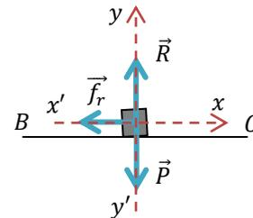
La distance  $BC$  :  $v_C^2 - v_B^2 = 2a' \cdot BC$  avec  $v_C = 0$ ,  $\Rightarrow BC = -\frac{v_B^2}{2a'} = 3.6 \text{ m}$
